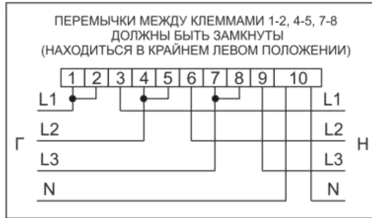
Рисунок Б.8– Схема включения счетчиков в корпусах W32 непосредственного включения на измерительных элементах трансформатора тока
