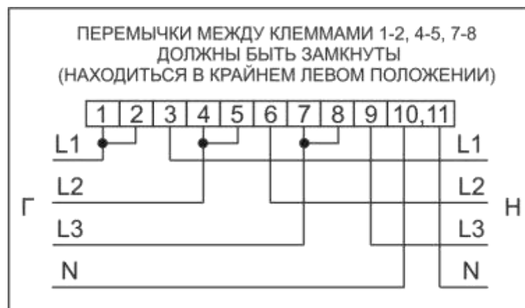
Рисунок Б.2 – Схема включения счетчиков в корпусах W31 и D33 непосредственного включения на измерительных элементах трансформатора тока
