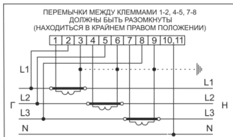
Рисунок Б.3 – Схема включения счетчиков в корпусах W31 и D33 через три трансформатора тока
